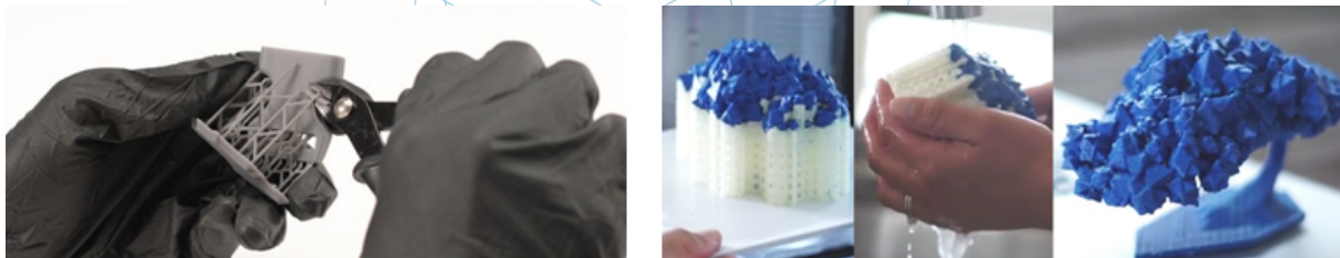
Figura 8: Proceso mecánico y baño para quitar las estructuras de soporte.
